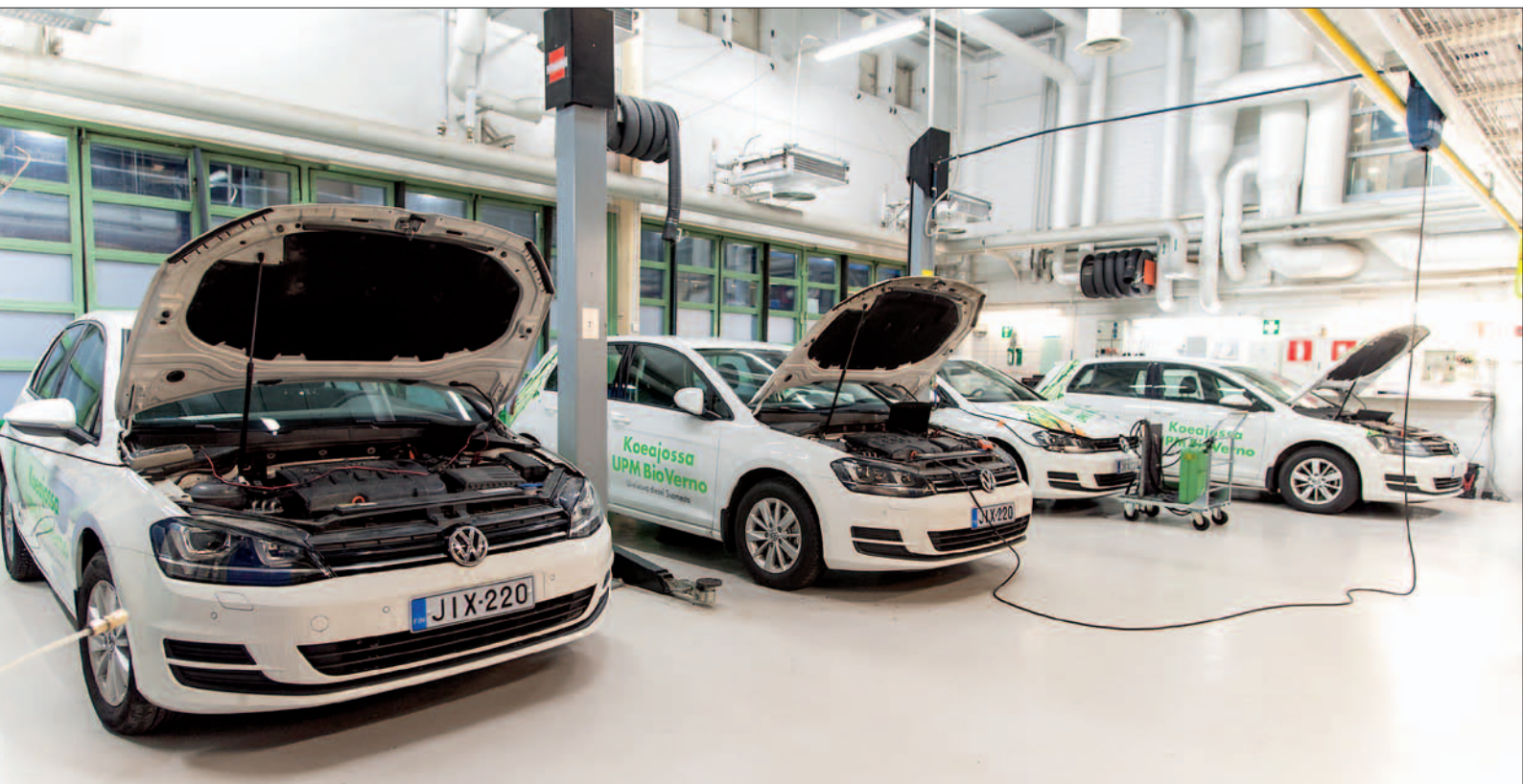
VTT tutki UPM:n puuperäistä BioVerno-dieselpolttoainetta ajamalla ja mittaamalla neljää uutta Volkswagen Golf 1.6 TDI -autoa.
