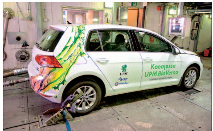
Autoilla ajettiin normaalit EU:n pakokaasutestit ja polttoaineen kulutusmittaukset sekä testipolttoaineella että vertailupolttoaineella.
